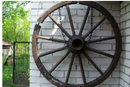
Fot.227. Koło okute stalową szyną stanowiło część jezdni wozu
