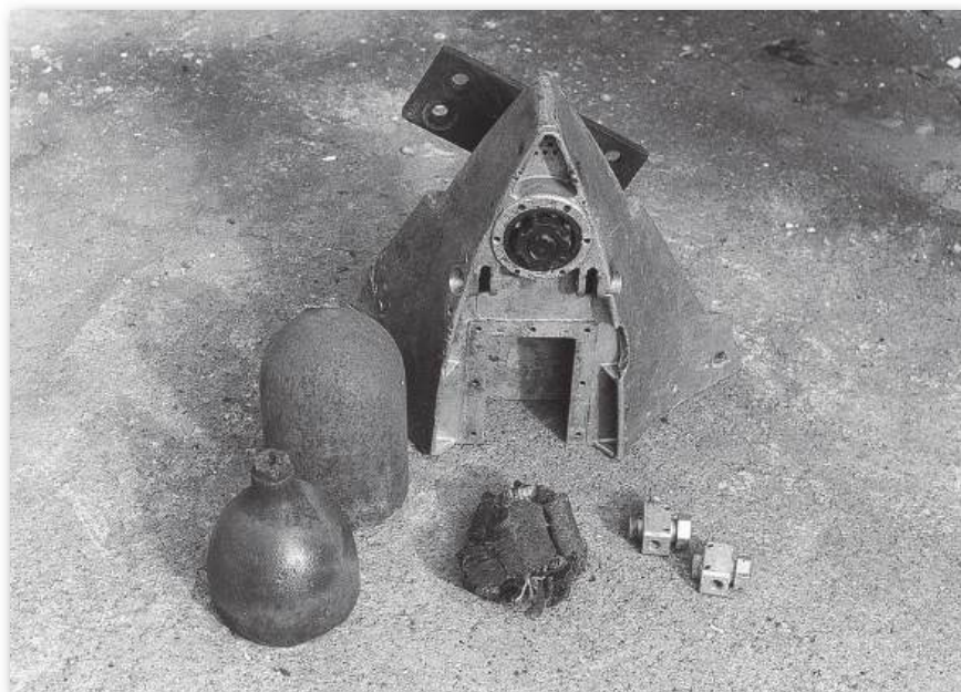
Zestaw szczątków z wybuchu V-2 na polu kolonii Podrączynie wsi Dąbrowa w pow. siedleckim. Od lewej: fragmenty butli na sprężone powietrze, podstawa sterów, zniszczony wirnik silnika elektrycznego i dwa zawory z instalacji gazogeneratora. Znany jest dokładny termin wydarzenia: sobota 27 maja 1944 r. o godz. 11.00 przed południem. (S.K., 1995)
