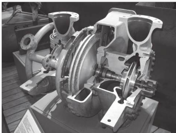
Peenemünde, MHT. Zespół pomp zaopatrujących silnik odrzutowy w spirytus i płynny tlen (w przekroju pogładowym). (S.K., 12 kwietnia 2019)
