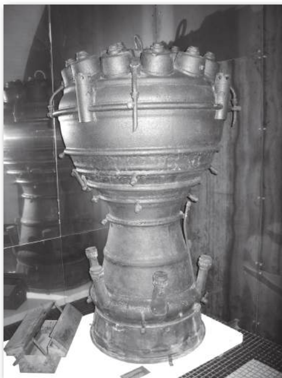
Peenemünde, MHT. Silnik odrzutowy rakiety. Od góry: kopuła wtryskiwaczy paliwa i utleniacza, komora spalania, dysza gazów wylotowych. (S.K., 12 kwietnia 2019)
